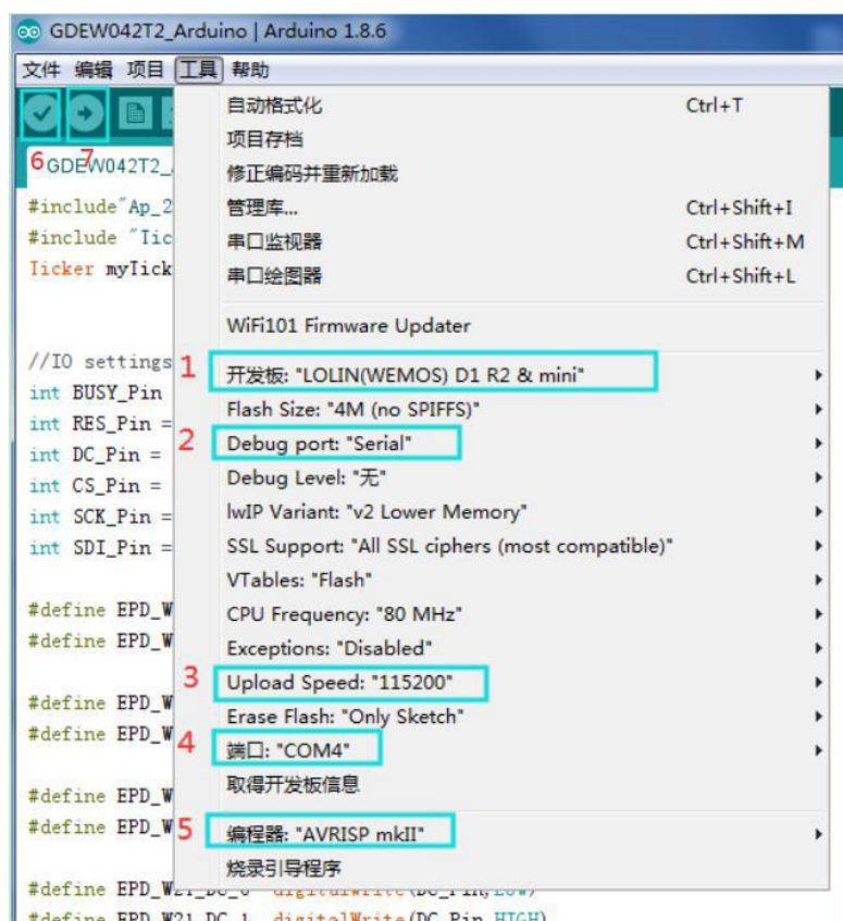
图 6 程序下载操作步骤
