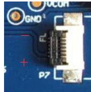
图 5 前置光板与转接板连接方式
