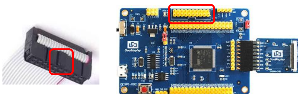
图 5 仿真器排线接口凸起及JTAG接口缺口
