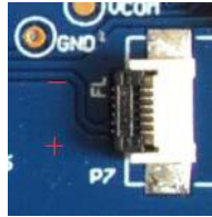
图 5 前置光板与转接板连接方式
